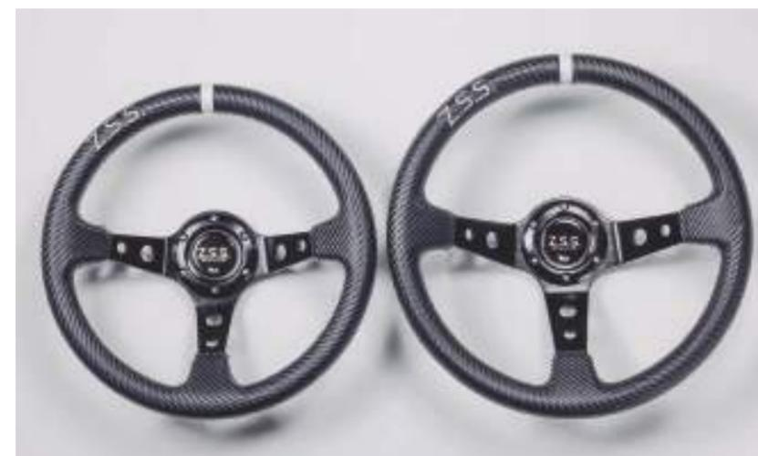
外径φ320、φ350共に95mmのディープコーンタイプを採用。ボススパーサーを使用せずに最適なドライビングポジションに調整が可能です。グリップはスエードタイプ、カーボンタイプ、パンチングレザータイプを設定。グリップ形状はコブの無い真円タイプにステアリングセンターマークを上部に配置することで、素早いステアリング操作を可能にしました。
